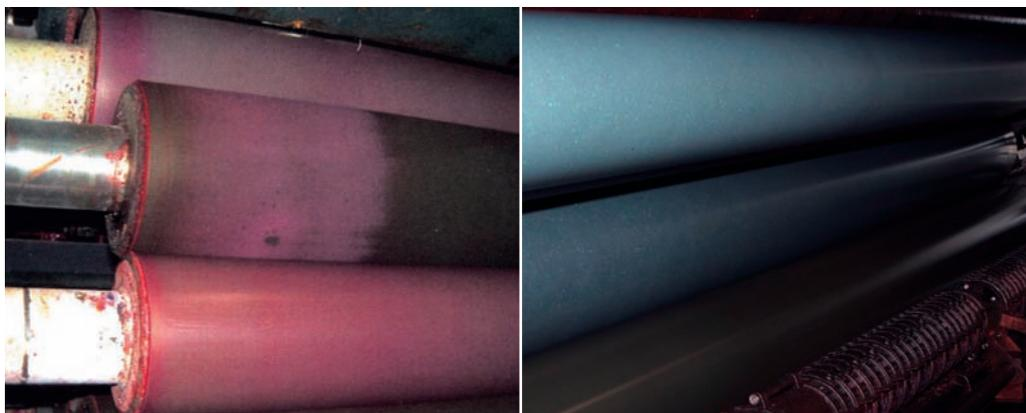
Abbildung links: Durch Kalziumkomplexe hydrophilisiertes Farbwerk hier im Endstadium. Dieser Prozess ist technisch schon lange wirksam, ehe er optisch in Erscheinung tritt (mit freundlicher Genehmigung durch U.Schmitt, Fogra, aus *Deutscher Drucker* Nr. 23/2006). Abbildung rechts: Blick in ein Loto-Tec-Farbwerk.
